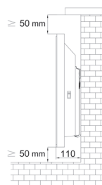
Рисунок 11. Полный вид расстояний готового монтажа прибора
